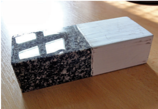
15. Žulová vzorka s hmotnosťou asi 1,8 kg, z polovice natretá termonáterom. Vzorku som uložil na dve hodiny do chladničky a po dôkladnom vychladnutí som ju vystavil izbovej teplote. Na nezateplenej časti vzorky sa v priebehu asi jednej minúty vytvorila viditeľná „mláčka“ kondenzátu. Zateplená časť ostala relatívne suchá a o poznanie teplejšia. Vlastné pozorovanie autora, leto, 2017.
