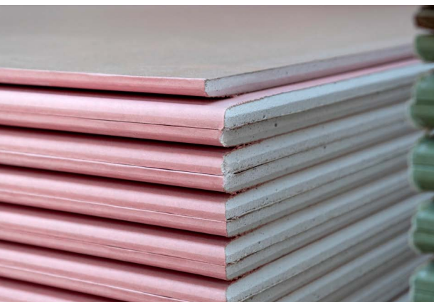
Protipožární sádkartonové desky na první pohled rozpoznáte podle růžového povrchu a červeného potisku označení (ISTOCK)
