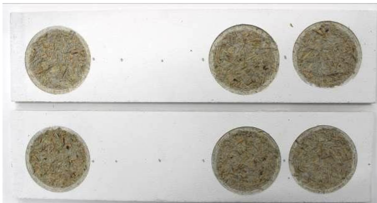
Foto dílů č. 1, 2 po odtrhové zkoušce - bez expozice
