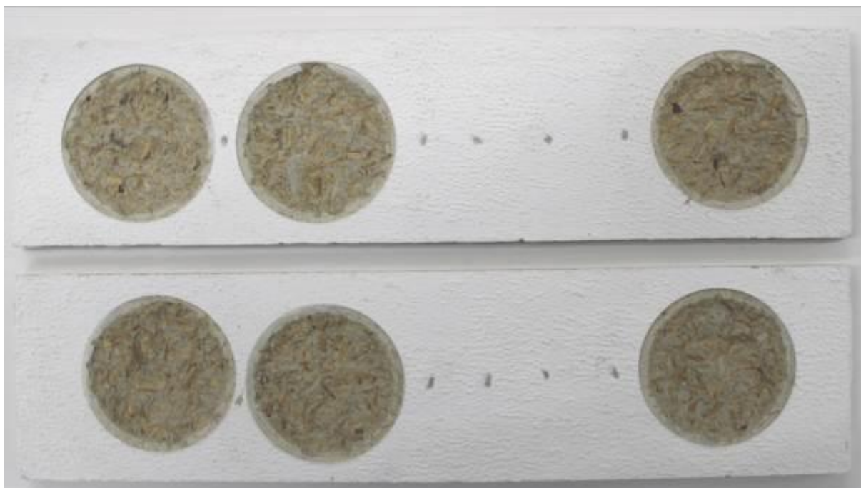
Foto dílů č. 1, 2 po odtrhové zkoušce - bez expozice
